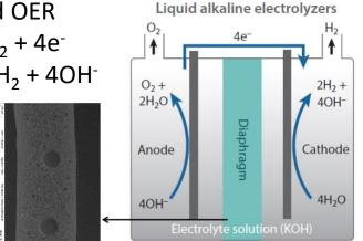
Anode  $40H^- \leftrightarrow 2H_2O + O_2 + 4e^-$ Cathode  $4H_2O + 4e^- \leftrightarrow 2H_2 + 4OH^-$
