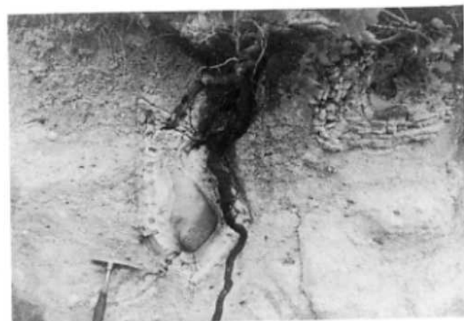
Tipica alterazione idrotermale «a cipolla» concentrica di blocchi coerenti all'interno di una matrice più fine.
